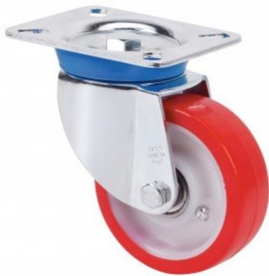
Ruedas con núcleo de nylon blanco y banda de poliuretano rojo dureza 90-95° shore A. Especialmente indicada para soportar altas cargas de hasta 600kg (1323lb).
